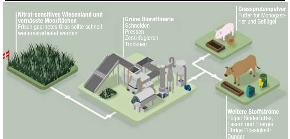
Vom Feld gelangt das Gras in die Bioraffinerie. Dort wird es zu pulverförmigem Eiweißfutter verarbeitet. Übrig bleiben eine faserreiche Pülpe und ein Grassaft, aus dem die Proteine entnommen wurden. | Grafik: GO-GRASS
